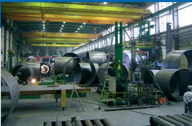
Fertigung Rohrschuss - Manufacturing of Cans
